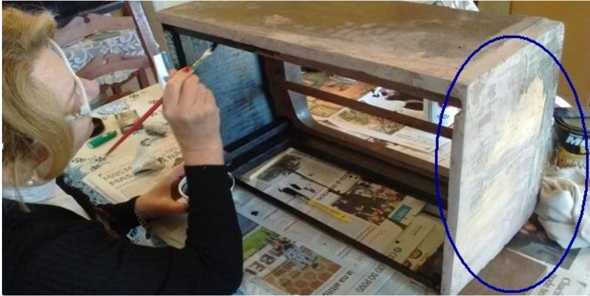
Esta lateral estava muito danificada. Restava fazer um desenho e cortar várias lâminas de madeira para restabelecer a superfície. A ação foi um exercício de *geometria de alfaiates*, num molde de papel para acertar as duas curvas, conforme se vê abaixo.
