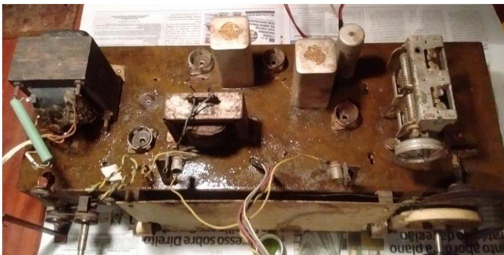
Surpreendentemente e mesmo guardadas por décadas num porão, o teste mostrou as válvulas ainda em condição de uso, e mais: a indicadora de sintonia (olho mágico), uma Siemens alemã EM34 (da década de 1930) deu performances de nova. No detalhe da foto abaixo, a Siemens EM 34.
