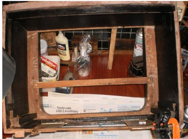
As fotos da caixa, quando ela iniciou ter firmeza. A construção e fixação dos ângulos restabeleceram o desenho original ao gabinete. Ao lado, a colocação de mais placas de Eucatex embaixo e junto aos cantos, firmando os ângulos em posição ortogonal.
